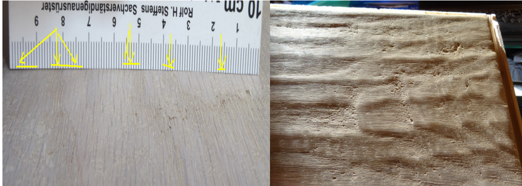
Bild 4: Unebenheit im Bereich der Frühholz-Gefäße. An der geraden Kante der Meßlehre sind Wellen von ca. 0,2-0,5mm erkennbar Bild 5: Die Gegenlichtaufnahme zeigt die spürbare Welligkeit der Oberfläche und die Unebenheit der Schälrisse
